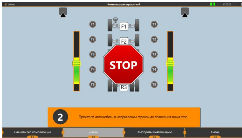
Рисунок 3.32 – Прокатка автомобиля назад
