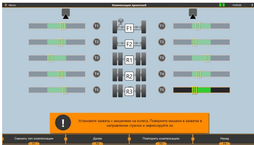
Рисунок 3.31 – Установка мишеней для компенсации прокаткой
