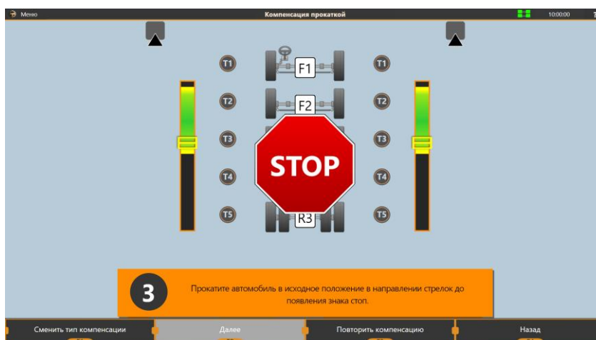
Рисунок 3.33 – Прокатка автомобиля вперёд
