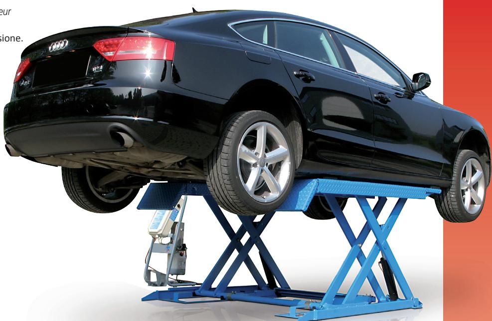
практическая Beschaffenheit und ein komfortables Arbeiten. Mechanische Gleichlaufregelung der beiden Fahrschienen, unabhängig von der Lastverteilung.
