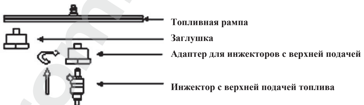
Рис. 2.1 Установка адаптера инжектора с верхней подачей топлива
